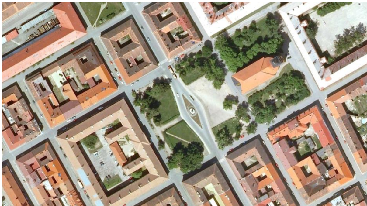
Slika 36. Primjer devijacije za usporenje prometa – situacija
